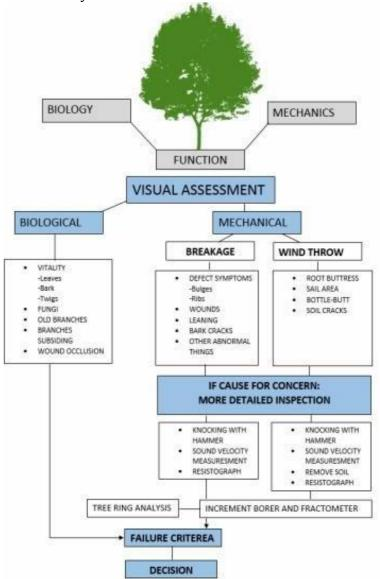
FIGURE 9- REPRESENTATION OF THE VTA SYSTEM.
